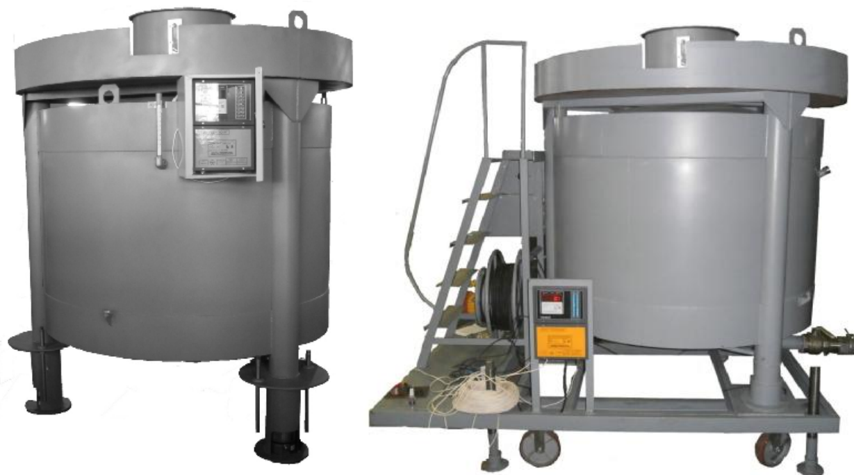
Рисунок 1 – Общий вид установок поверочных средств измерений объема и массы для верхнего и нижнего налива УПМ-2000
